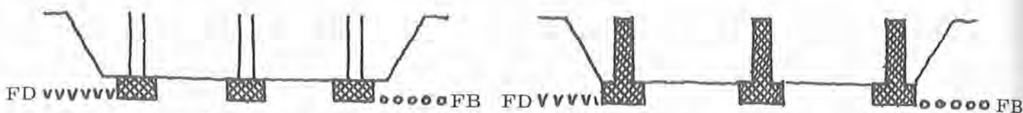
1. Fundering for skeletbygninger (Plan og snit 1:200)
